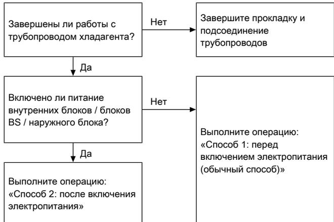
Крайне важно, чтобы все работы с трубопроводом хладагента выполнялись при отключенном питании блоков (наружного, блока BS и внутренних блоков). При включении питания блоков инициализируются расширительные клапаны. Это значит, что клапаны закроются.
