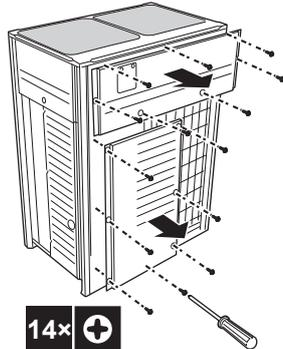
Открыв передние панели, можно добраться до распределительной коробки. См. раздел «14.2.2 Как открыть распределительную коробку наружного блока» [▶ 28].
