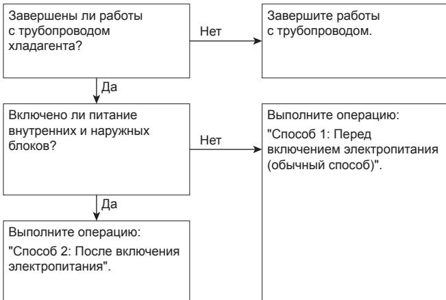
Крайне важно, чтобы все работы с трубопроводом хладагента выполнялись при отключенном питании блоков (наружных и внутренних). При включении питания блоков инициализируются расширительные клапаны. Это значит, что клапаны закроются.
