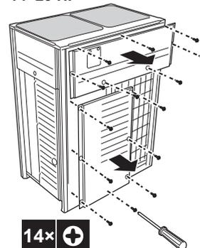
После того, как передние панели будут открыты, можно получить доступ к блоку электрических компонентов. См. раздел "6.2.2 Как открыть блок электрических компонентов наружного блока" на стр. 25.
