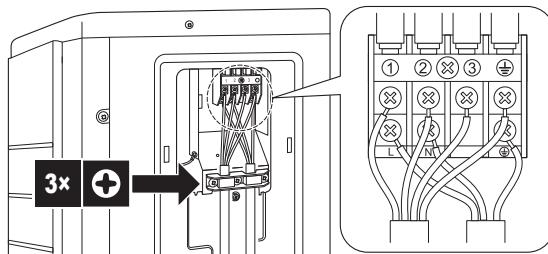
**5** Надежно затяните винты клемм. Рекомендуется пользоваться крестовой отверткой.
