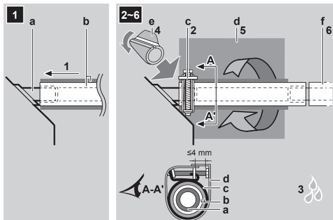
a Соединение сливного трубопровода (с блоком)
